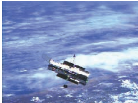
〈사진 설명〉 왼쪽 사진은 아레시보 전파 망원경으로 커다란 산의 골짜기 전체(지름 : 305m)를 차지하고 있다. 오른쪽 사진은 허블 우주 망원경으로, 반사 거울의 크기는 2.4m이고 전체 길이는 버스 정도의 크기인 13m이다. 현재 지상에서 약 610km의 고도에서 지구 둘레를 돌고 있다.(사진 제공 : NASA)
