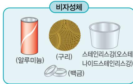
**비자성체** : 알루미늄, 크롬, 백금 등과 같은 물체는 자석에 붙지 않아 '비자성체'라고 한다. 그러나 자석에 붙는 스테인리스강 중에도 18-8 스테인리스강은 자석에 붙지 않는다. 18-8 스테인리스강은 크롬과 니켈이 함유된 철 합금이지만 자석에 붙지 않는다. 18-8 스테인리스강은 주로 싱크대에 사용하는 것으로 오물이 잘 묻지 않고 녹이 슬지 않는 장점을 가지고 있다. 이들 물질이 자석에 붙지 않는 까닭은 원자 내부에 자석의 성질을 가지는 전자가 서로 반대방향으로 운동을 하고 있어서 자석의 성질을 띄지 않는 것이다.
